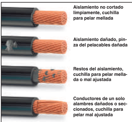
Fallo de aislamiento según DIN IEC 60352
