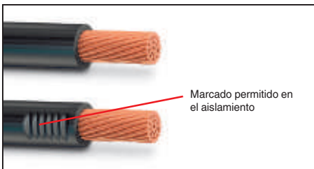
Cable pelado correctamente según DIN IEC 60352
