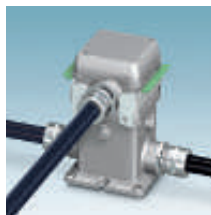
DUPLICON, distribuidor T 7 x 4,0 mm 2 , 690 V / 25 A, conexión por tornillo
