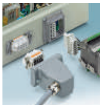
HEAVYCON, clavija del aparato modular 3-n x 1,5...22,0 mm 2 , hasta 1000 V / 10-100 A, técnicas de conexión diversas
